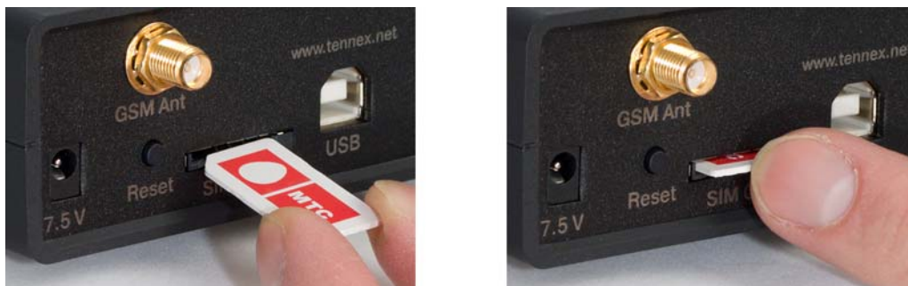
Рис. 3. Установка и извлечение SIM-карты.
