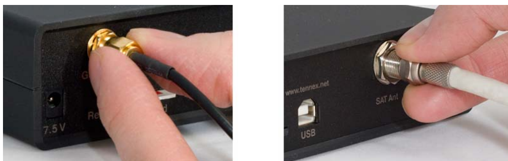
Рис. 4. Подключение кабелей GSM- и спутниковой антенн.
