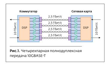
Это возможно, поскольку DSP-процессор подключен ко всем витым парам кабеля, а внутренние помехи – коррелированные с сигналами в витых парах.
