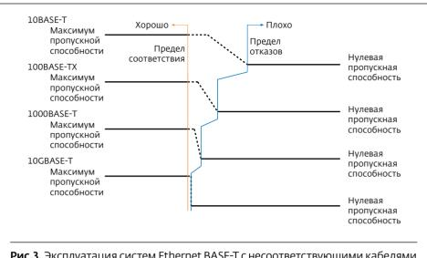
**Рис.3.** Эксплуатация систем Ethernet BASE-T с несоответствующими кабелями
