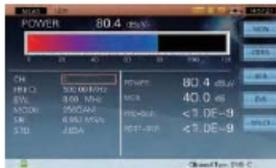
Измерение качества сигналов QAM
